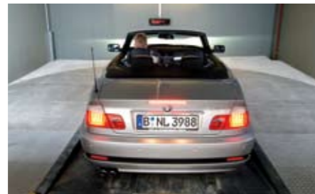
Scanner laser posti sul soffitto dell'area di trasferimento controllano il corretto posizionamento dell'auto.
