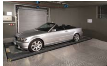
Dato che l'area di trasferimento è posizionata ad un'angolazione di 90° verso il livello di parcheggio, l'auto viene girata di 90°
